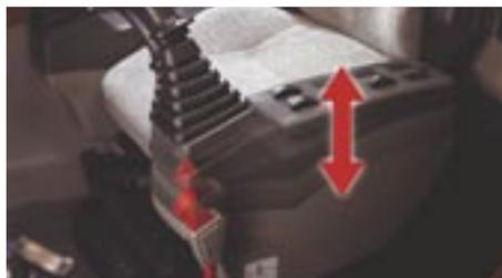
Control de movimientos (joystick) ajustable en altura
