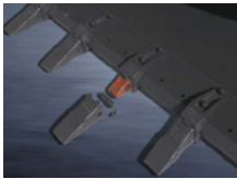
Diente de 2 piezas (adaptador para pasador + empernado)
