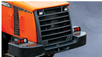
Rejilla del radiador (de acero)
