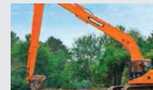
ALCANCE SUPER LARGO - SLR Y SEMI SLR Nuestras máquinas con alcance largo son ideales para tareas en tierra y en agua con un alcance máximo de unos 20 metros.
