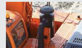
FILTRO DE AIRE LAVADO CON ACEITE Mejora la limpieza de la toma de aire en zonas muy polvorientas, como ser en canteras.
