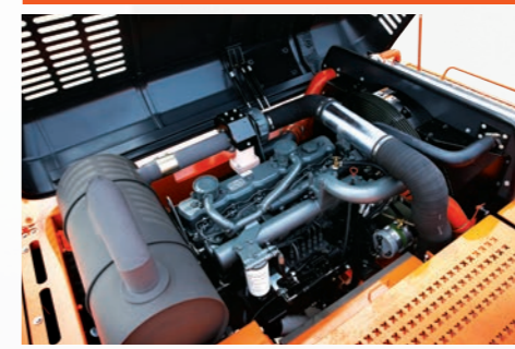
Motor mecánico con filtros de alta eficiencia
