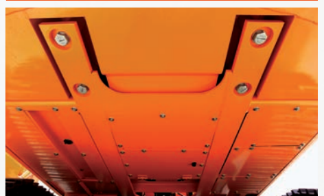
Cubierta inferior reforzada para trabajos pesados
