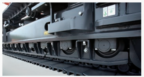
Protector del tren de orugas de tipo enterizo y componentes del chasis totalmente resistentes a los trabajos pesados
